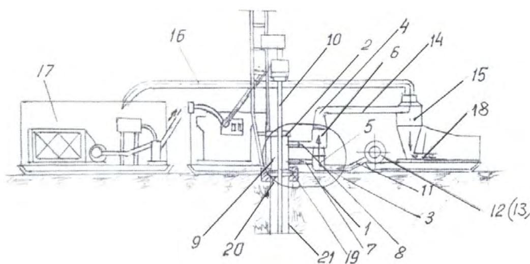
Сур.1. Ұғы. 1 - герметик; 2 - нұсқаулығы түтік; 3, 4 - реактивті қондырғылар; 5, 6 - камералардың жарылғыш құрылғысын араластыру; 7, 8, 11 - құбырлар; 9 - айналма құыс; 10 жетекші құбыр; 12 (13) - энергия көзі (компресор); 14 - реактивті құрылғының 4 ағынды құбыры; 15 - сусpenзияны бөлуге арналған құрылғы; 16 - сусpenзия бөлуге арналған құрылғының шығыс құбыры; 17 - бүрғылау қондырғысының жұмыс қабілеттілігі; 18 - бөлінген сусpenзия ағынды құбыры; 19 - ауыспалы табақша; 20 - атаяу; 21 - баған.
