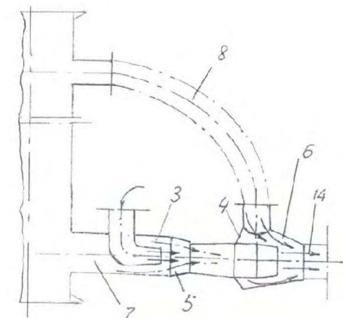
Сур.2. Ағындық құрылғылардың конструкциялары: а - тік, б - көлденең. 2 - нұсқаулығы түтік; 3, 4 - реактивті қондырғылар; 5, 6 - камералардың жарылғыш құрылғысын араластыру; 7, 8, 11 - құбырлар; 14 - ағындық құрылғыдағы шығыс құбыры 4.
