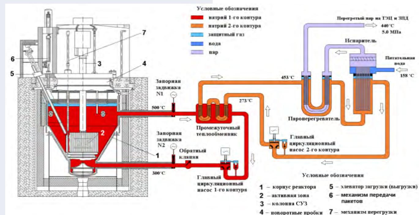
**Принципиальная технологическая схема реактора БН-350 петлевого типа с трехконтурной схемой теплоотвода (натрий-натрий-вода)**
