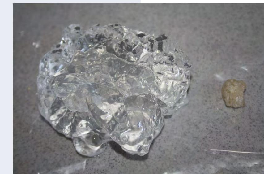
Рисунок 1. Фотография таблетированного сухого и набухшего суперабсорбента
