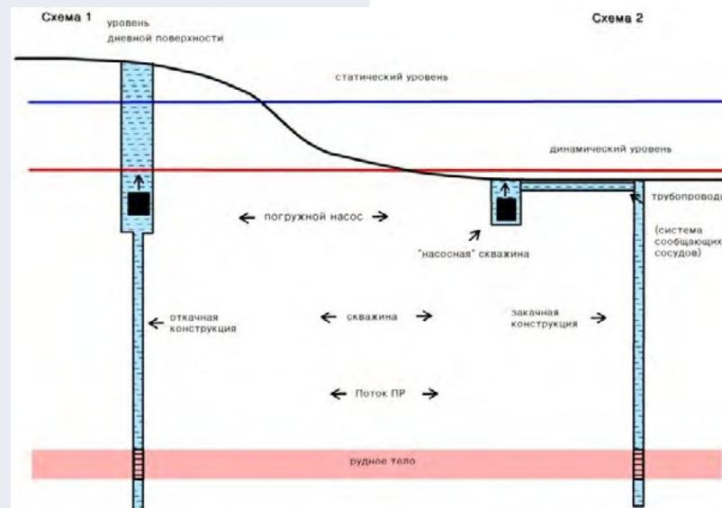
Рис. 1. Схема применения «насосных» скважин в различных гидродинамических системах
