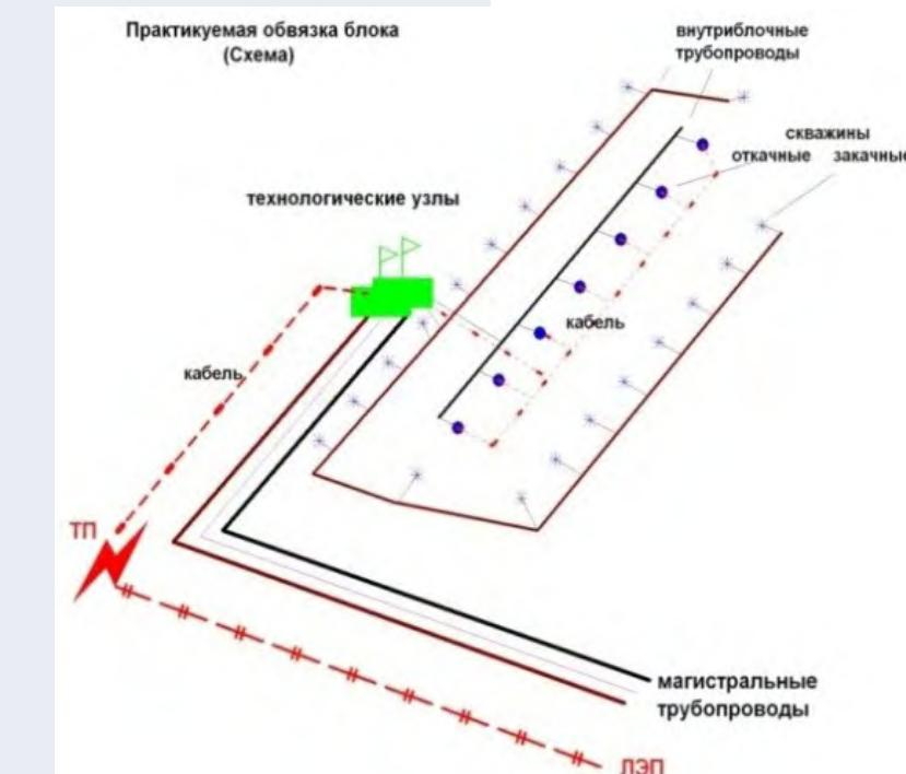
верхний торец скважины соответственно более дорогим оголовком; к месту расположения технологического узла и каждой такой скважины от ТП и от узлов распределения растворов прокладываются электрокабели (рис.2).
