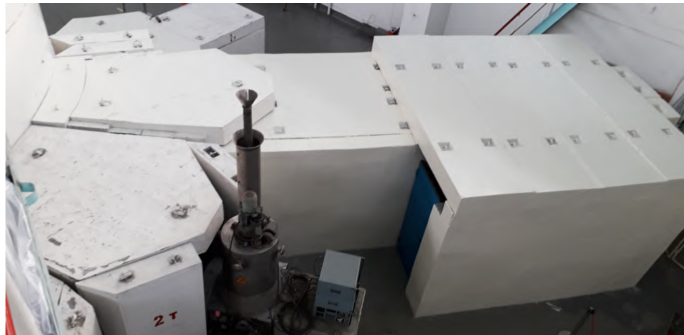
1-сурет. Нейтронды рентгенография және томография орнату (жоғарғы көрініс)
