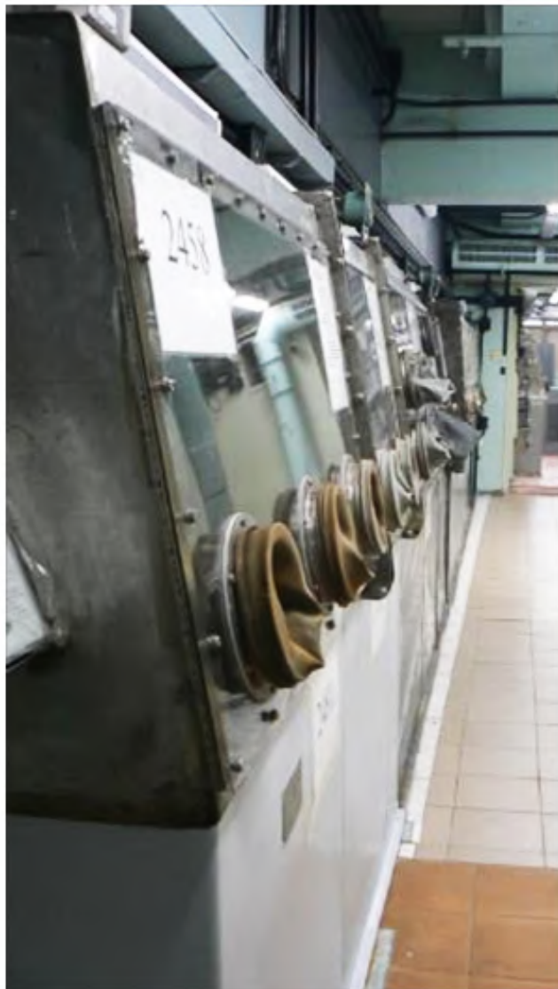
Қолғап қораптары бар жаңа технологиялық желі
