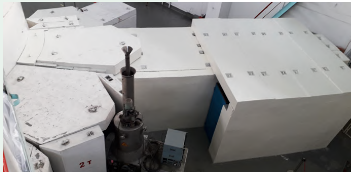
Рис.1. Установка нейтронной радиографии и томографии (вид сверху) Fig. 1. Installation of neutron radiography and tomography (top view)
