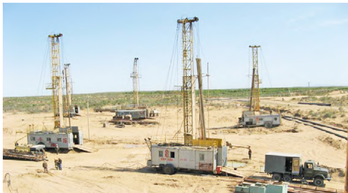
1-сурет. «Волковгеология» АҚ бұрғылау агрегаттары уран кен орнында технологиялық ұңғымаларды бұрғылауды жүргізуде
