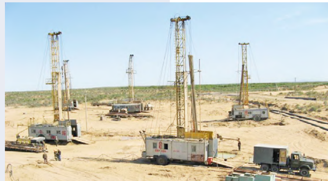
Рисунок 1. Буровые агрегаты АО «Волковгеология» ведут бурение технологических скважин на месторождении урана
