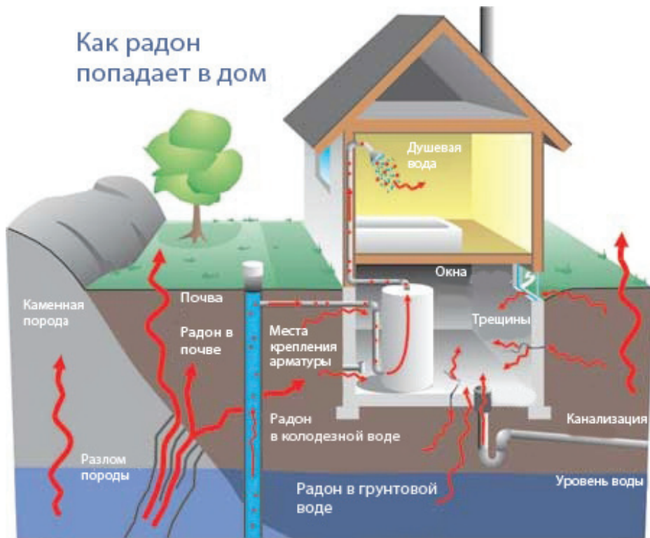
Рис. 13. Схема проникновения радона на земную поверхность и в жилище
