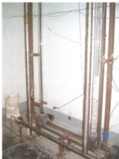
Рисунок 4. Варианты исполнения хлоратора из кварцевого стекла и стали 0Х18Н10Т.
