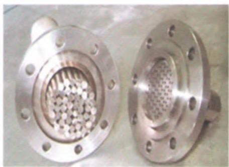
Рисунок 5. Элементы фильтра хлорида кобальта.
