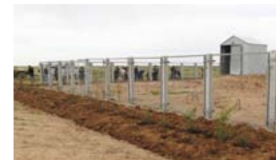
5 сурет. «Курчатов» инфрадыбыстық топтың элементтері біреуінің сыртқы көрінісі (қоршаудың периметрі бойынша бұта жел бөгеуілдерін азайту үшін).
