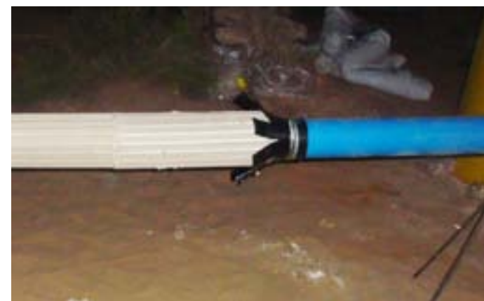
2-сурет. Құрылған кездегі төменгі пакердің және гильзалар жиынтығының келбеті
