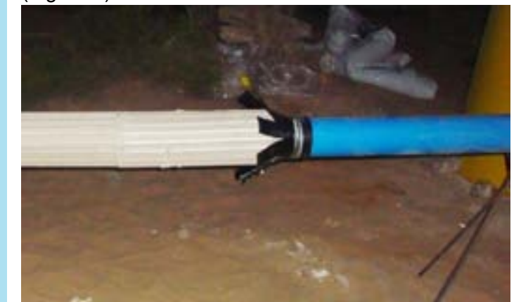
Рисунок 2. Вид нижнего пакера и набора гильз в собранном состоянии Figure 2. View of build-up bottom packer and set of sleeves
