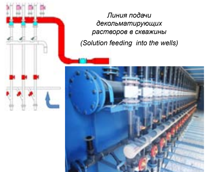
Рис. 1 Схема и фотография стационарного узла проведения химических обработок скважин в системе ТУППРа. Figure 1. Layout and picture of Down-the-hole treatment node in Pregnant Solution Processing Assembly (PSPA).
