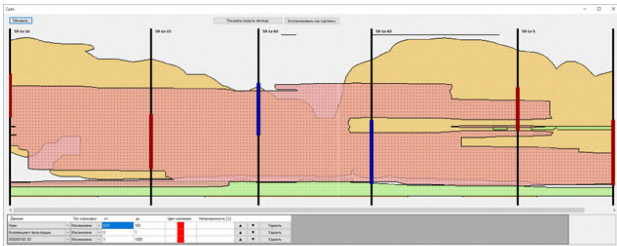
3-сурет - СЕ ең аз концентрациясы 3 г/л (қызыл сары) блоктың 160 жұмыс күніне арналған қышқылданатын көлемі. Үстіне 0,01% - дан жоғары (кірпіш) және сүзу коэффициенті СК 1 м/тәуліктен төмен (жасыл) минералдың контуры салынған
