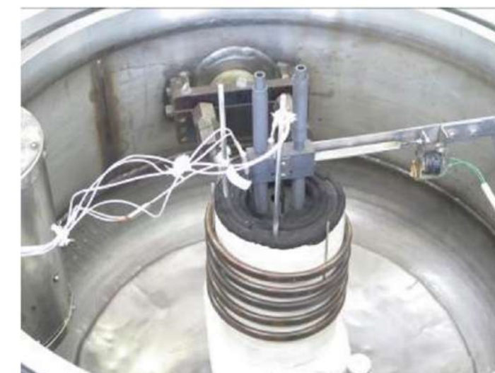
Сурет 1 – ВЧГ-135 қондырғысының жұмыс камерасындағы эксперименттік жинақ 1 – Графитті тигель, 2 – Қақпақ, 3 – Вольфрамнан жасалған стақан, 4 – Кориум, 5 – Металл-суытқыш, 6 – Термопара, 7 – Металл-суытқышты төгуге арналған құрылғы, 8 – Электромагнитті жетегі
