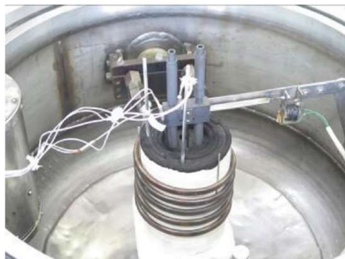
Рисунок 1 – Экспериментальная сборка в рабочей камере стенда ВЧГ-135 1 – Тигель графитовый; 2 – Крышка; 3 – Стакан из вольфрама; 4 – Кориум; 5 – Металл-охладитель; 6 – Термопара; 7 – Устройство сброса металла-охладителя; 8 – Электромагнитный привод
